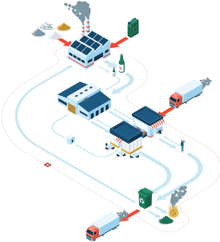
Materialströme der Produktion und Verwendung von Glasflaschen in der Schweiz: Situation heute
